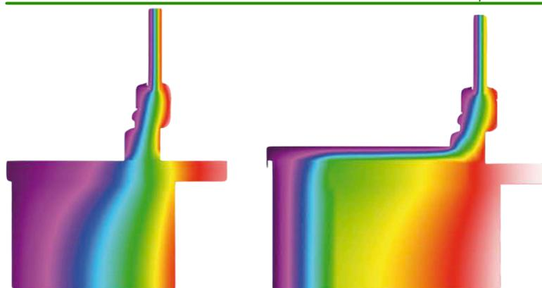
Spessore complessivo 28mm, /so/onte con conducibilità termica pori o 0.034W/mK e Resistenza termica Rd 0.60 (mq K/W)
